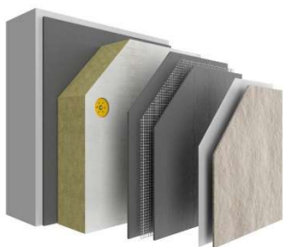
Zateplení kce minerální izolací – hlavní plochy
